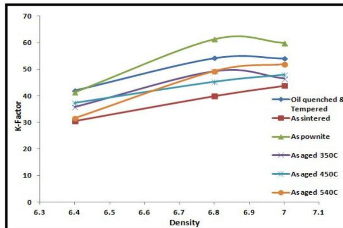
Fig. 11 Toughness parameter vs density
